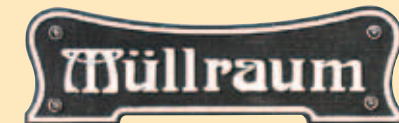
Tafelstil: D Text laut Tabelle Breite: 290 mm, Höhe: 90 mm Material: Aluminium- oder Messingguss (Hintergrund schwarz lackiert, Rand und Zeichen aufgeschliffen)
